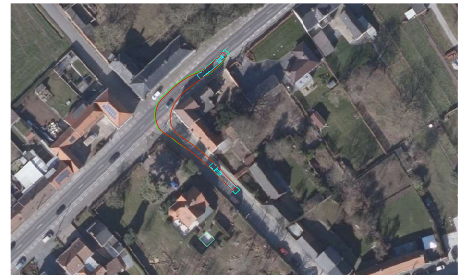
ENKELRICHTINGSSTRAAT RICHTING OUDENAARDSESTEENWEG UITRIJDEN UIT DE KAAISTRAAT OP DE OUDENAARDSESTEENWEG, RICHTING DE ROTONDE IS ONMOGELIJK DOOR DE BESTAANDE BEBOUWING OP DE HOEK VAN DE KAAISTRAAT EN DE OUDENAARDSESTEENWEG.
